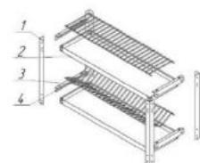
3. Прикрепить кронштейны сушки (поз. 4) к опорам (поз. 1) при помощи болтов, гаек и шайб;
