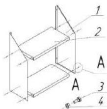
1. К полке (поз. 1) при помощи винтов (поз. 3) прикрепить боковые стенки (поз. 2);
