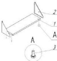
1. К полке (поз. 2) при помощи болта M6x12 (поз. 3) и гайки M6 (поз. 4) прикрепить боковые стенки (поз. 1);
